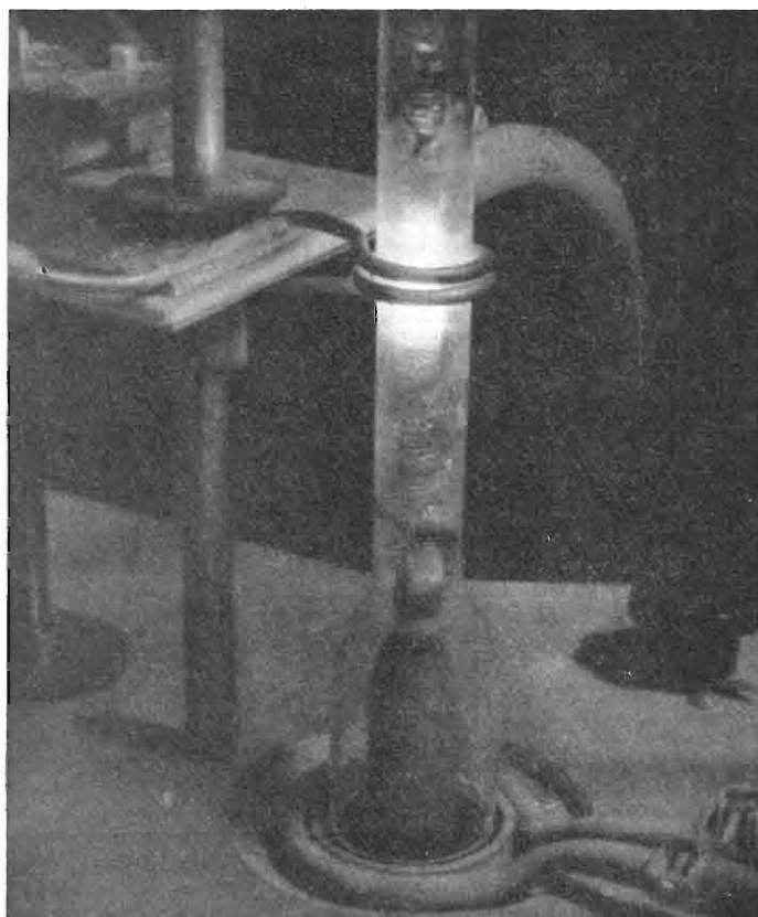
In questa fotografia è raffigurata invece una fase assai delicata della produzione dei cristalli di silicio. Si tratta di un forno con riscaldamento AF per la purificazione del silicio con il metodo della zona flottante. Tale metodo evita l'impiego di un crogiolo, suscettibile di apportare impurità al silicio fuso. Per la prima volta nella storia della metallurgia, l'industria ha chiesto una raffinazione della materia prima tale da non lasciare più di un atomo di impurità ogni 10 milioni di atomi di silicio o di germanio. Da ciò è possibile rendersi conto di quali e quante difficoltà si siano dovute superare prima di poter iniziare la fabbricazione industriale dei diodi al germanio o al silicio e ancor più dei triodi a cristallo.
