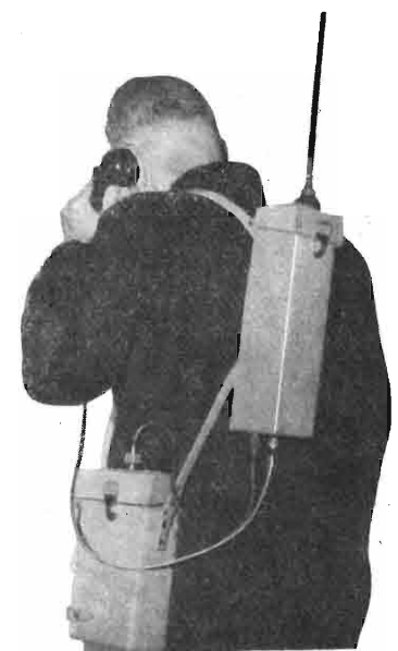
Fig. 13 - Il «gesaphon 21», con potenza di uscita di circa 1 W.
