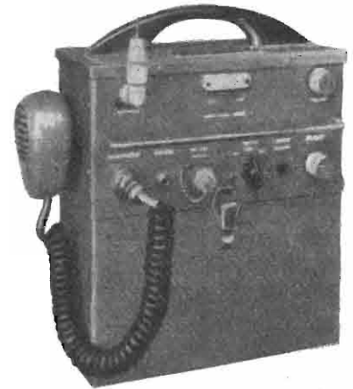
Fig. 11 - Altro ricetrasmittitore portatile: il «pak-fone» della Industrial Radio Co. Potenza di uscita, circa 1 W.
