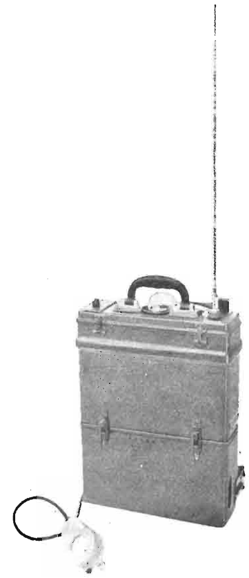
Fig. 18 - Il «portophone» Philips. Potenza 250 mW.
