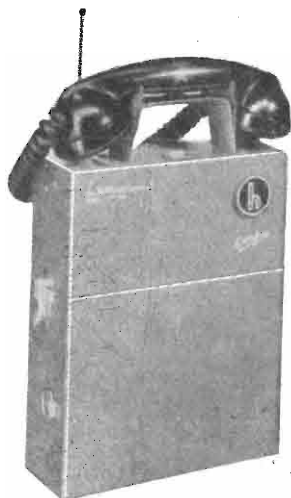
Fig. 22 - L'«hand-carry» della Hallicrafters. Potenza 1 W.
