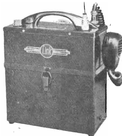
Fig. 10 - Ricetrasmittitore portatile della Link Radio Co., ad FM. Potenza di uscita 750 mW.
